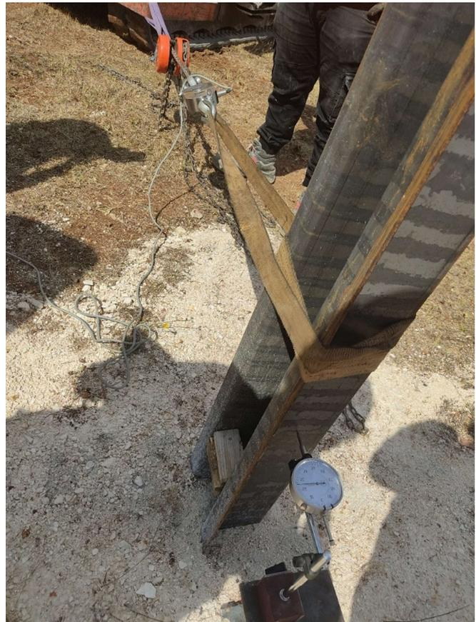
Vengono applicati, ad un'altezza di 500 mm fuori terra, cicli orizzontali di carico/scarico in maniera incrementale, fino al raggiungimento del  $T_{200} = 200\%$  di  $T_{\text{oriz, test}}$ : dopo una prima fase di precarico, il carico  $T_{200}$  viene raggiunto tramite steps di 50%.
