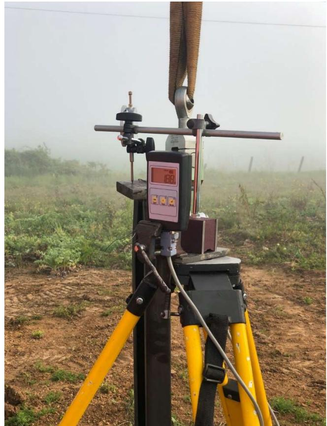
Viene applicato il carico verticale di trazione in maniera incrementale, per fasi, fino al raggiungimento del  $N_{t200} = 200\%$  di  $N_{traz, test}$ : dopo una prima fase di precarico, il carico  $N_{t200}$  viene raggiunto tramite steps di 50%.
