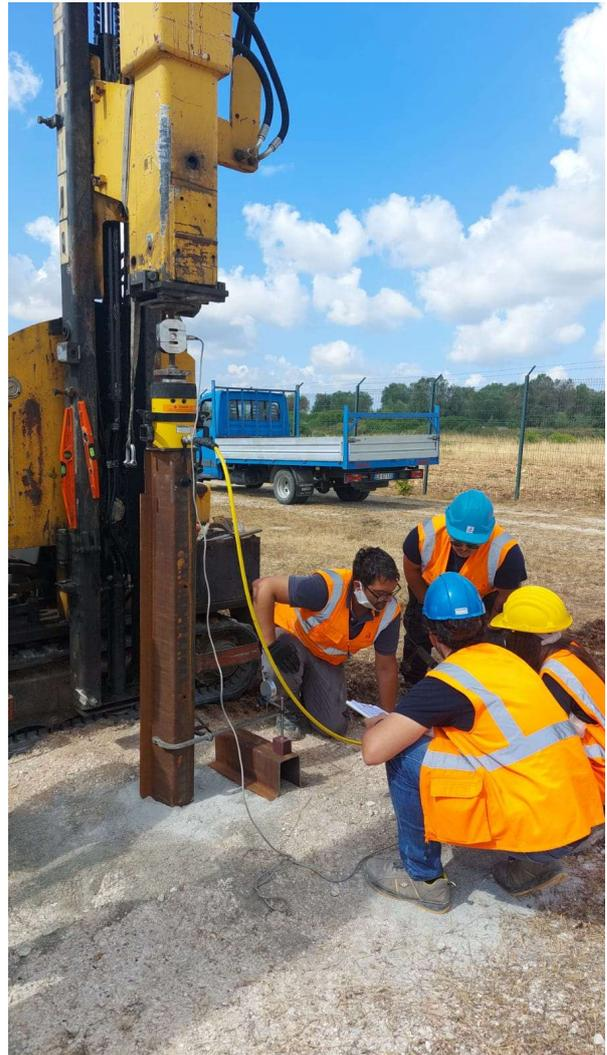
Viene applicato il carico verticale di compressione in maniera incrementale, per fasi, fino al raggiungimento dell' $N_{c200} = 200\%$  di  $N_{comp, test}$ : dopo una prima fase di precarico, il carico  $N_{c200}$  viene raggiunto tramite steps di 50%. L'aumento del carico per ogni fase successiva, viene applicato senza consentire la sua possibilità di decrescita.
